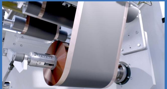
Oben: Flexible Drehrichtung der Abwickleinheit
